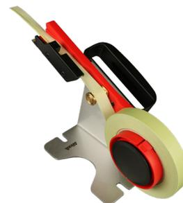
Die umgeklappte Kante unter die schwarze Kantenabdeckung schieben und Band nach vorn ziehen. Beim Weiterziehen des Bandes wird die Kante automatisch und gleichmäßig umgeklappt.
